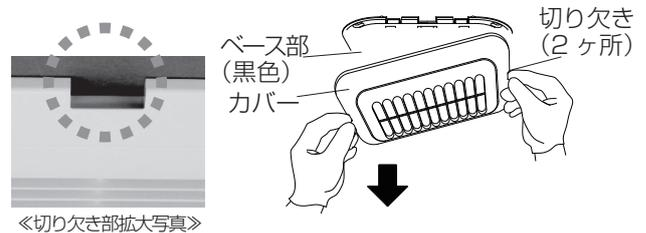
1. カバー額縁の切り欠き両サイドに指をかけ、親指はカバー表面を押え、つまむ様な状態でどちらか片側を手前に引いて取り外してください。(もう一方の手はカバー部分を押える形としてください)
