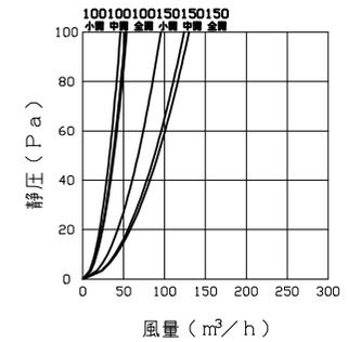
※この圧力損失曲線はKRP-BW/KRP-BWNにTF-A-KRP（トレフィン）を取り付けた性能を表しています。
